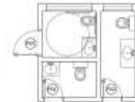
Det. 03 - Disposição dos Sanitários Sem escala
